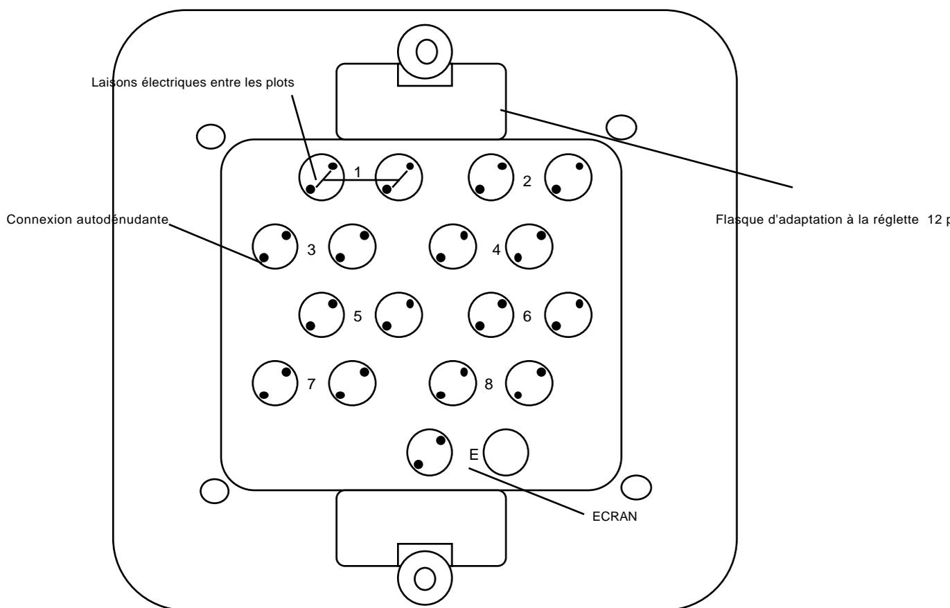
Le module de raccordement ARNOULD est livrée dans un boîtier de réglette 12 plots.
